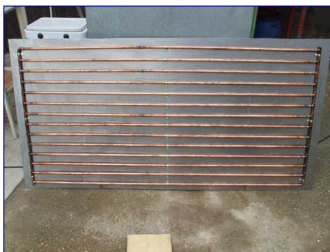
Zdjęcie 12 System rur miedzianych (źródło: http://www.douamaini.ro/ )
